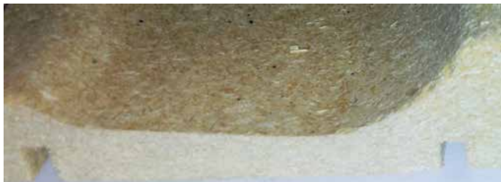
Listwa profilowa z wiórow - trocin niesmukłych spod frezarki i piły.
