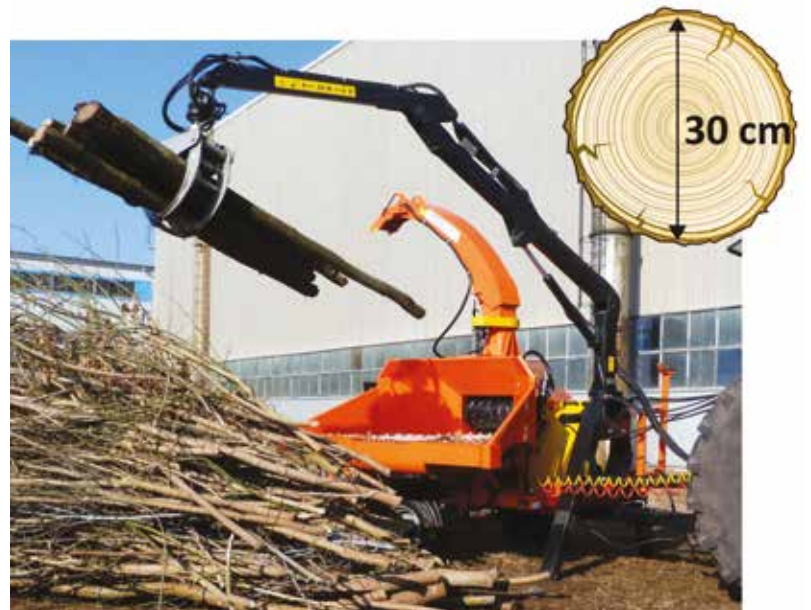
Skorpion 350 RBP i Skorpion 500 RB są wyposażone w wydajny system załadunku drewna w formie dwóch transporterów gąsienicowych.
