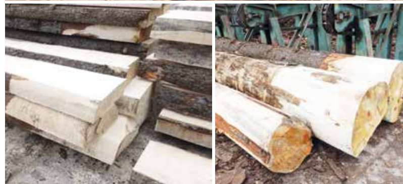
Reduktor napływów korzeniowych Baljer & Zembrod wyeliminował konieczność ręcznego usuwania klinów, które, jako pozostałości po napływie korzeniowym, zakleszczały się pomiędzy piłami traka ramowego. Fot. Baljer & Zembrod
