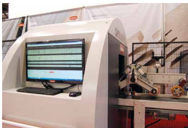
Opti Scan 4 to skaner, który czyta wymiary geometryczne elementu oraz wykrywa obecność wad występujących w drewnie.
