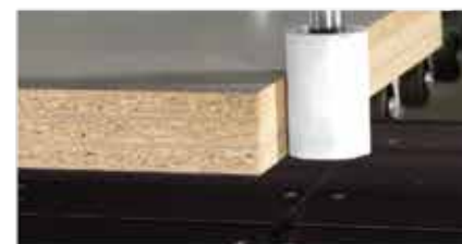
Rollka dociskająca materiał zapewnia precyzyjne cięcia pod kątem
