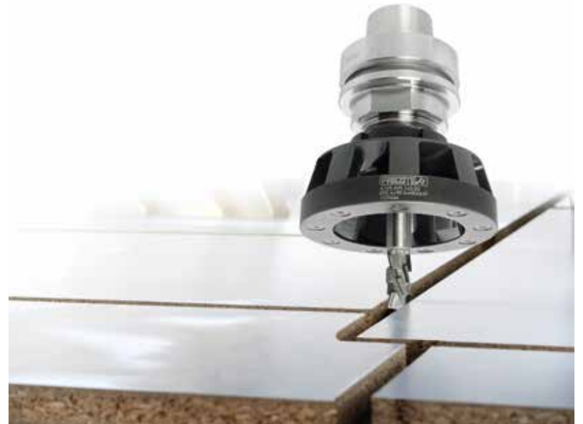
Odległość między systemem TORNADO a obrabianym materiałem powinna być regulowana w zakresie od 3 do 5 mm. Fot. FREZITE
