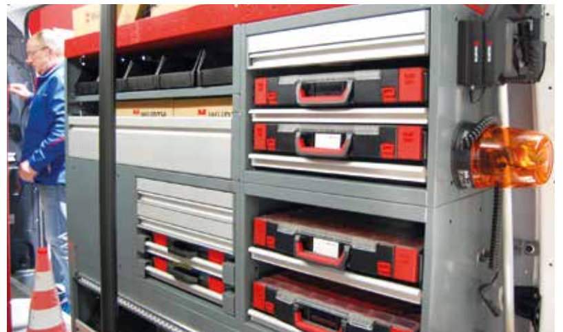
Szuflady i komory zabezpieczone zostały przed wysunięciem, a luźne i większe elementy mogą być przyłączone specjalnymi pasami, które są na zamontowanych w środku uchwytach.
