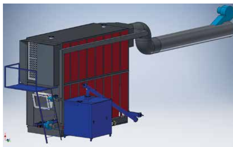
Kocioł ZGH 3000 z systemem ogrzewania powietrza pierwotnego i wtórnego.
