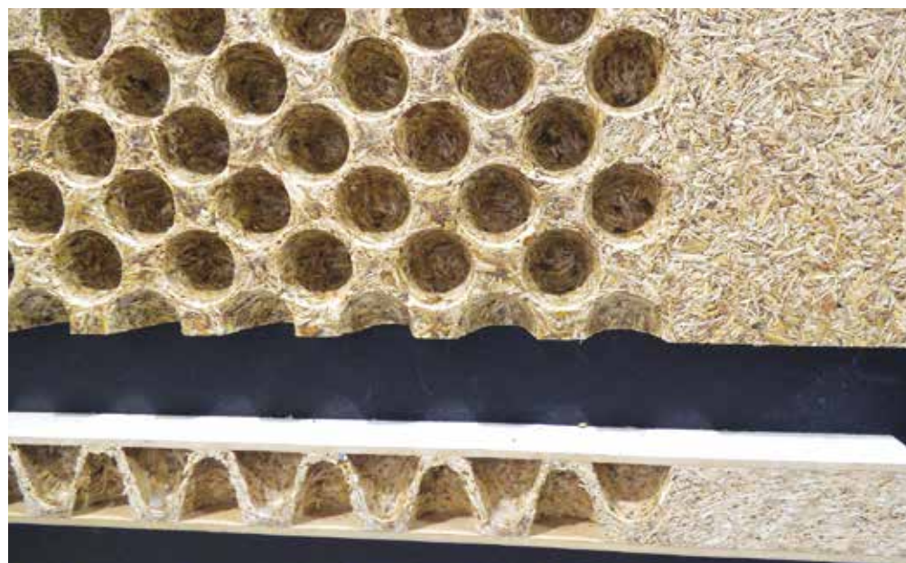
Płat drzewiowy - produkcja drzwi z wiórow w jednym cyklu prasowania.
