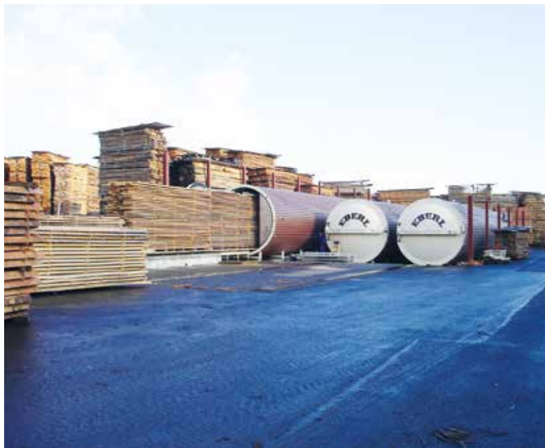
Dzięki wyposażeniu suszarni próżniowej w pompę ciepła powstała energooszczędna suszarnia EBERL, którą dodatkowo uzupełniono w nowy sposób napowietrzania z zapewnionym stałym napowietrzaniem poprzecznym, wymagającym jedynie niewielkiej ilości energii elektrycznej do osuszania drewna, bez konieczności zapewnienia dopływu wody i ciepła, czyli posiadania kotłowni. Fot. PFZ
