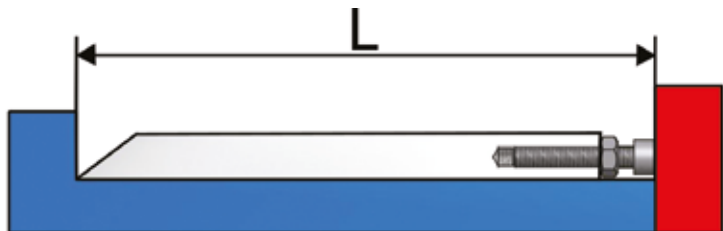
Konstrukcja noży tnących.
