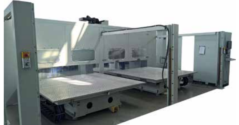
W maszynie zbudowanej dla fabryki BERO został zastosowany również inny, dodatkowy układ elektryczny. Jest to system inteligentnego odzysku energii powstającej podczas hamowania silników elektrycznych, w które maszyna jest wyposażona, np. każdej z interpolowanych osi maszyny.
