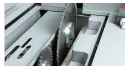
Wózek pilarki z agregatem pily głównej i podcinacza
