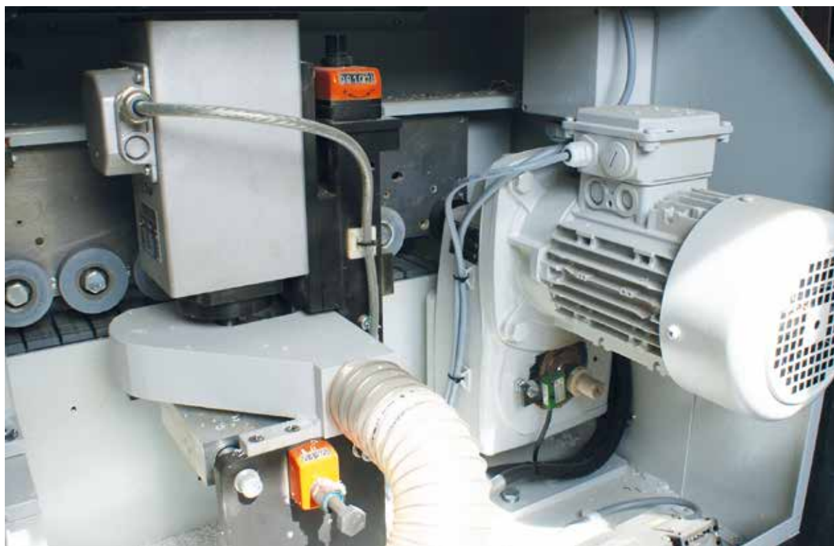
Hebrock Polska na życzenie firmy Gregor zamontował dodatkowy agregat frezujący.
