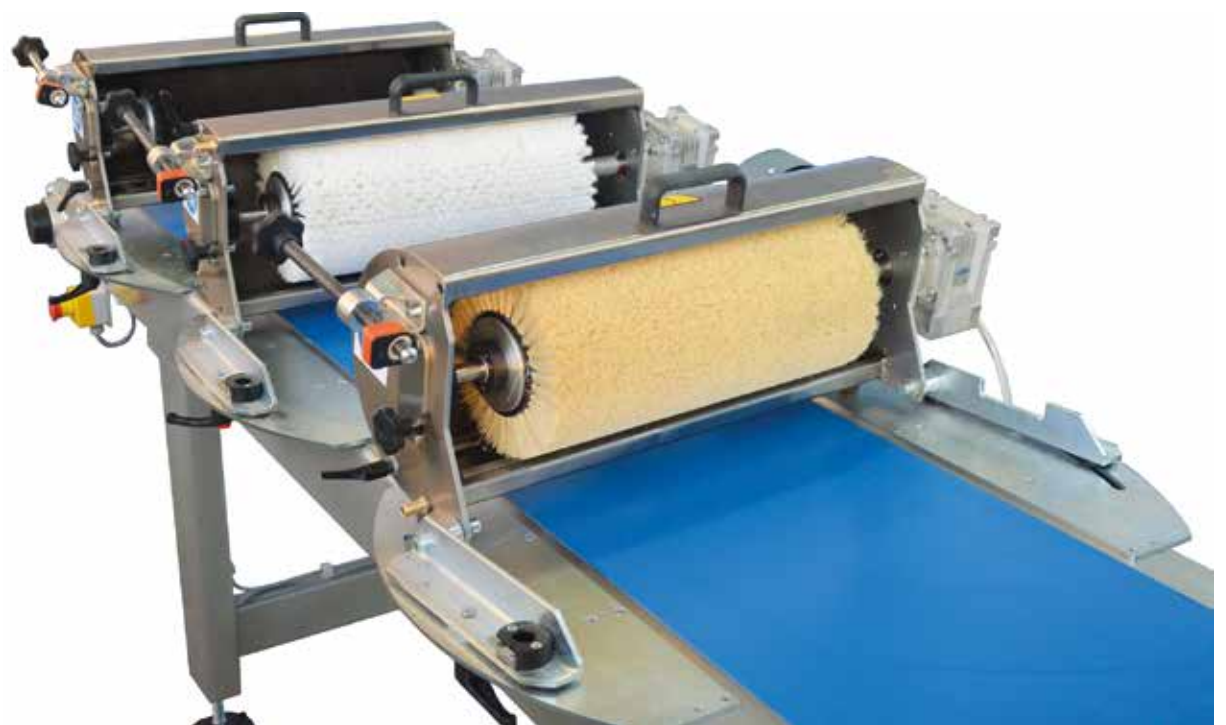
Pierwsze dwie jednostki rozcierające o kształcie talerzowym typu szczotka czy też pads mają za zadanie równomierne roztrzaskanie czynnika na powierzchni deski. Fot. Prochera
