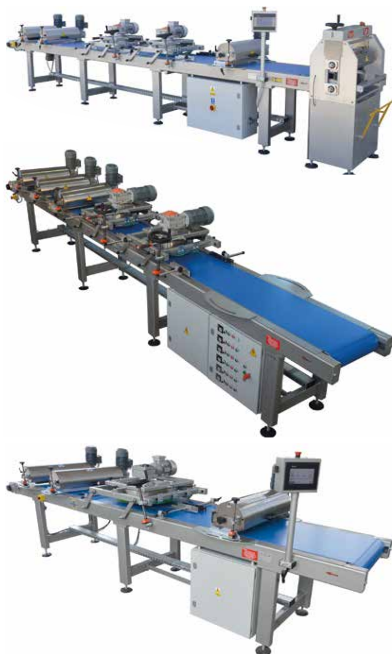
Standardowa linia olejowa składa się z walcowej nakładarki WN-450 oraz przenieśnika taśmowego, na którym zamontowane są trzy jednostki rozcierające. Zadaniem walcowej nakładarki oleju/wosku jest równomierne nanoszenie czynnika na powierzchnię drewna. Fot. Prochera
