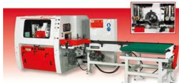
GLUEMAC zadowolili najbardziej wymagających producentów płyty klejonej. W maszynie zastosowana jest technologia strugania bocznych powierzchni drewna (tych najważniejszych przy klejeniu) narzędziem w postaci frezu o dużej średnicy pracującego powierzchnią czółową. Frezy te jednocześnie strugają lewą i prawą powierzchnią elementu, co zapewnia idealne klejenie. Fot. LEADERMAC
