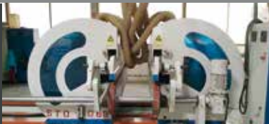
Formatyzerko-czopiarka; 2011r., wymiary obrabianych elementów: długość: 210-2500 mm; grub. 8-80 mm, jedynie 420 mth.
