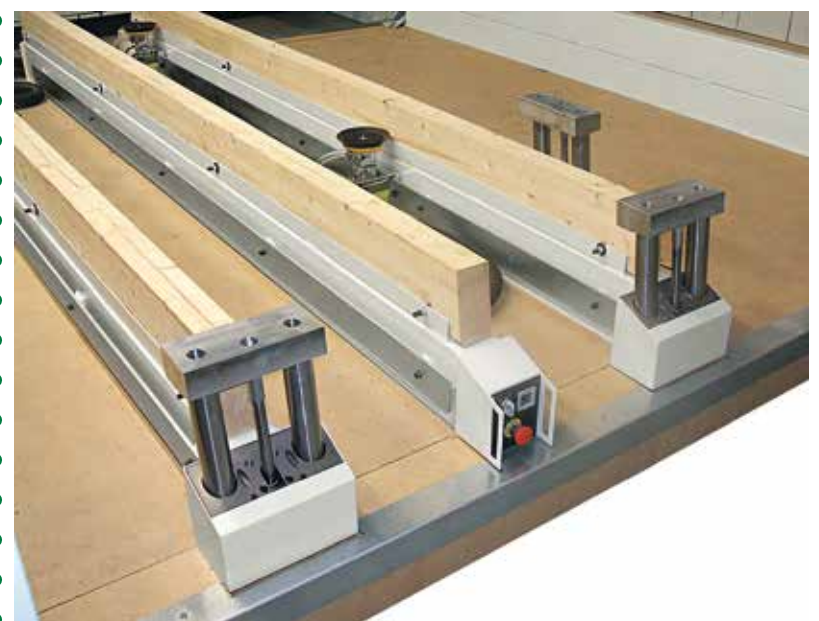
Z uwagi na wykorzystanie w modelu Area stołu z drewnianymi belkami, zastosowano agregat do planowania powierzchni.
