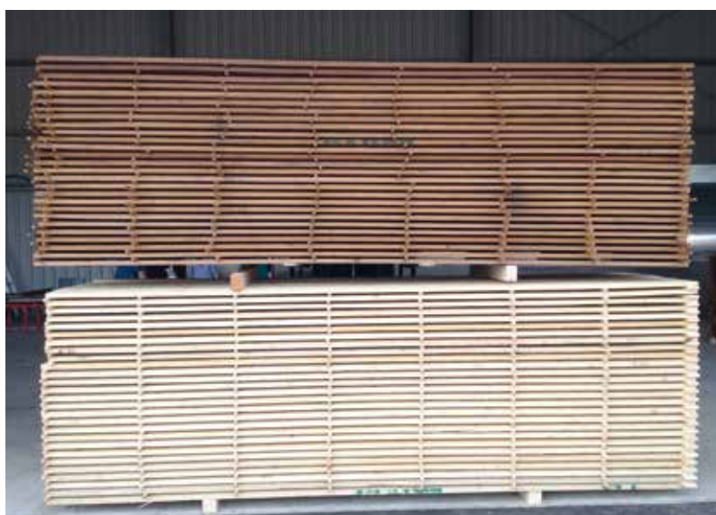
Wynikiem procesu TERMOVUOTO jest drewno o ciemnym przebarwieniu, jednorodnym na całej grubości.
