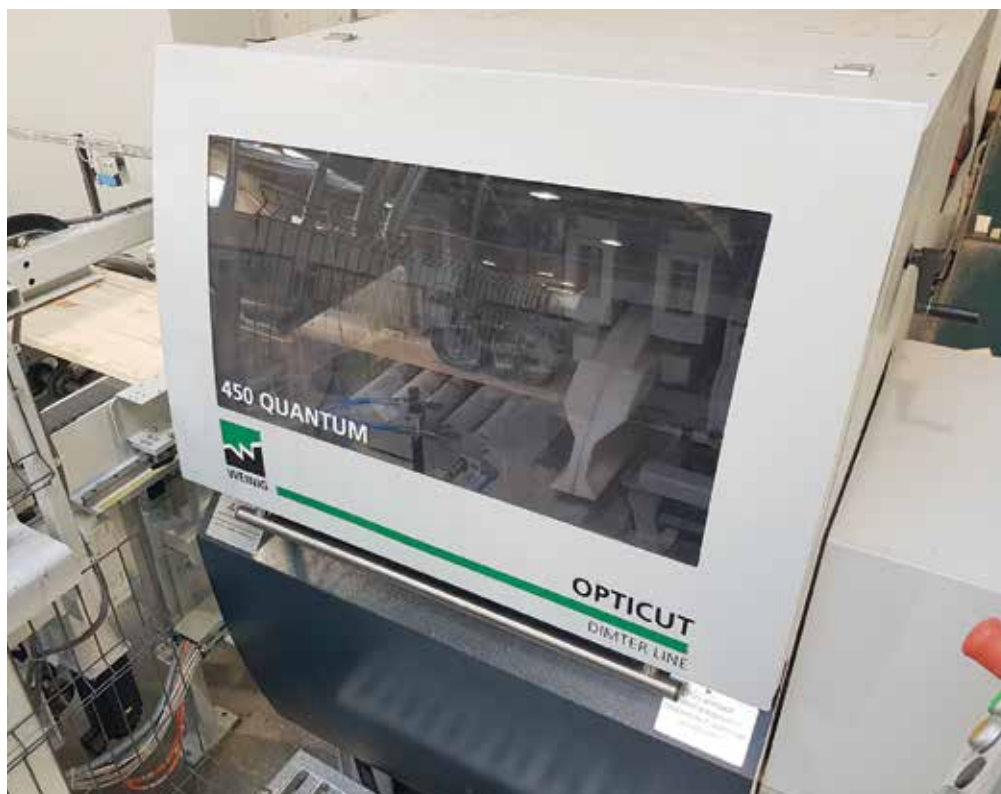
W zakładzie zainstalowano także dwie pilarki optymalizujące cięcie poprzeczne OptiCut 450 Quantum.
