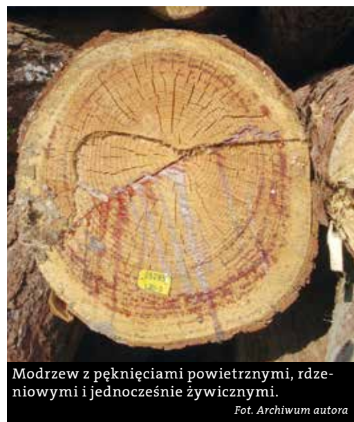
Widoczne na przekroju podłużnym pęknięcie rdzeniowe w drewnie modrzewia z wyciekającą żywicą - tzw. pęknięcie żywiczne. Fot. Archiwum autora
