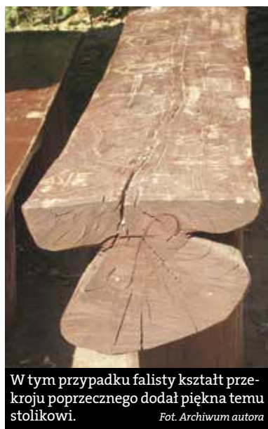
Widoczna na czole siatka pęknięć spowodowana wysychaniem drewna nosi nazwę pęknięć powietrznych. Fot. Archiwum autora
