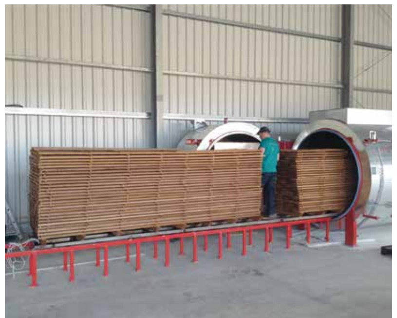
Maszyny WDE Maspell są uniwersalne, ponieważ mogą spełniać funkcję suszarni próżniowej oraz pieca do próżniowej termo-chemicznej modyfikacji drewna.
