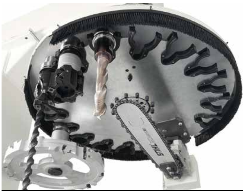
Oikos posiada magazynek zdolny pomieścić 18 narzędzi różnego typu, w tym piły: tarczową i łańcuchową.
