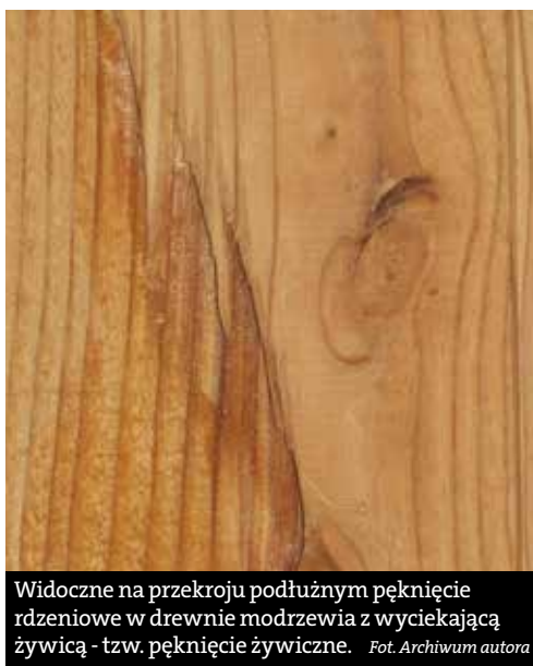
Modrzew z pęknięciami powietrznymi, rdzeniowymi i jednocześnie żywicznymi. Fot. Archiwum autora
