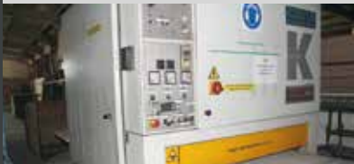
Szlifierka Costa KAWA CT 1350, rok 2002, szer. 1350 mm, wałek skrawający, wałek gumowy, trzewik.
